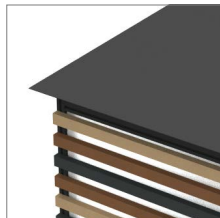
アルミ板2t平リブ溶接 塗装仕上
